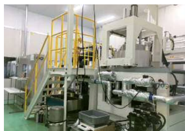
図1(上) 超臨界二酸化炭素を用いたデカフェ処理工程。湿潤生豆から抜けたカフェインは、超臨界二酸化炭素の流れに乗って少量の水とともに除去される。
